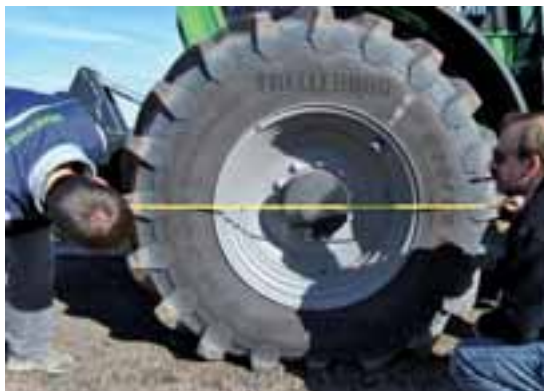
Las ruedas de ambos ejes se midieron con exactitud para determinar la relación mecánica.
