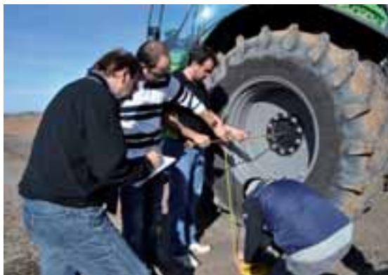
Las ruedas de ambos ejes se midieron con exactitud para determinar la relación mecánica.
