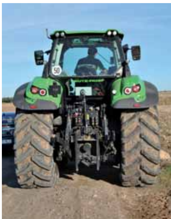
Los guardabarros fraseros integran controles remotos del elevador, TDF y un distribuidor hidráulico.
