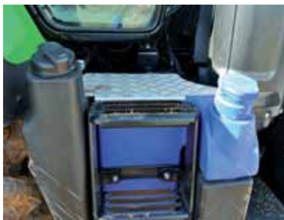
El motor Deutz TCD, de 263 CV, incluye la tecnología SCR que utiliza urea.
