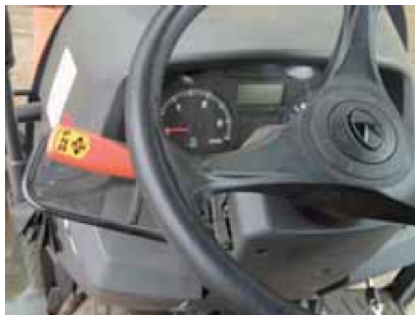
Palanca inversora a la izquierda del volante.
