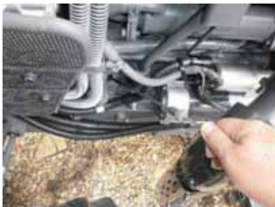
Comprobación del nivel de aceite del motor.
