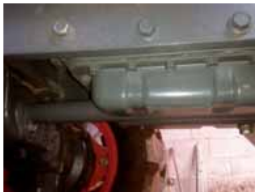
Encapsulado de la transmisión al eje delantero.
