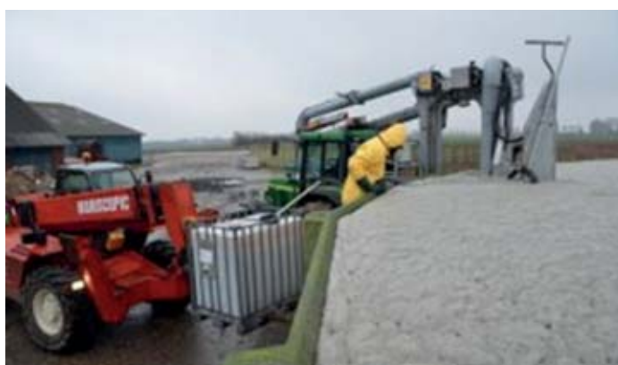
Figura 1.- Acidificación de purín en el depósito mediante inyección y mezcla de ácido sulfúrico. Arriba, a la izquierda, proceso de inyección y mezcla con tractor. Arriba, a la derecha, tubos de inyección y dispositivo mezclador. Abajo, vista del depósito de ácido y de la espuma formada. Fotografías de Torkild Birkmose, SEGES.
