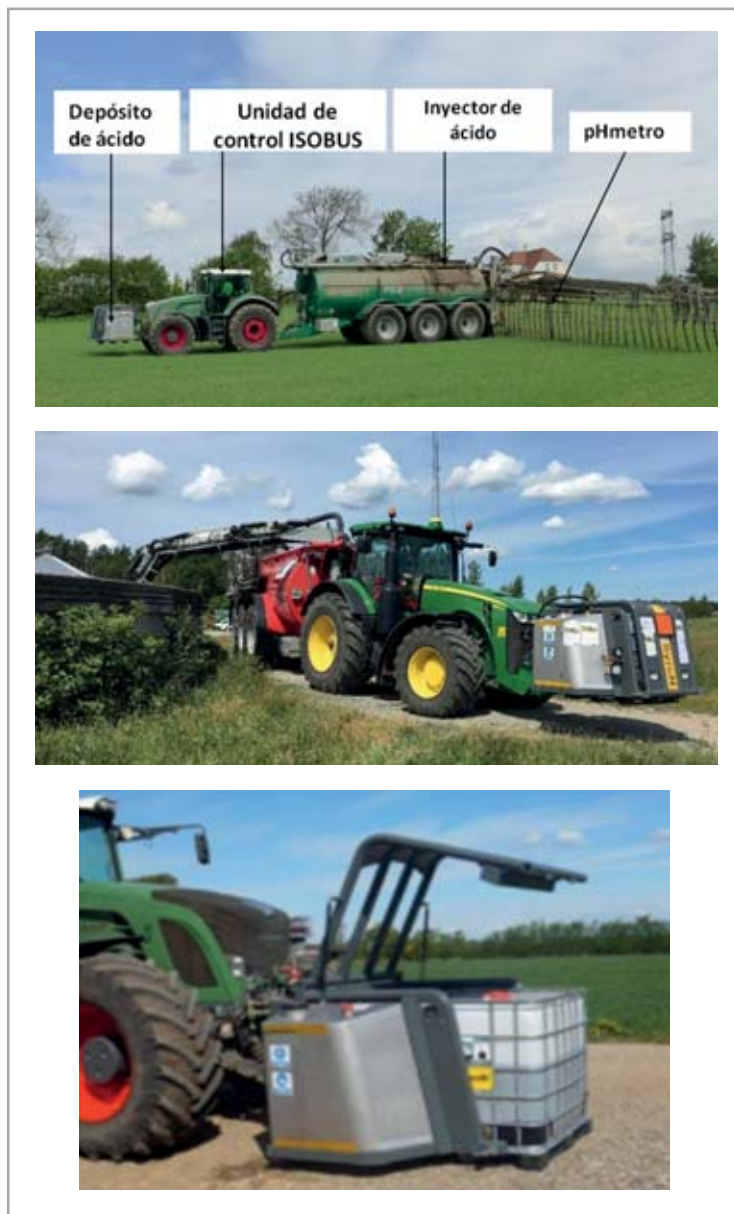
Figura 2.- Equipos de acidificación de purín durante la fertilización. Arriba, en una aplicación con distribuidor de mangueras. En el centro, en la fase de toma. Abajo, detalle del tanque de ácido.
