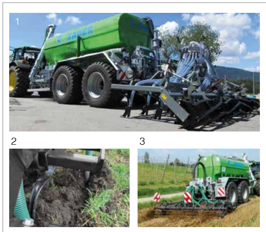
Figura 5.- Sistema de inyección de purín con rejas de cultivador elásticas. (1) vista general del sistema. (2), detalle de trabajo con la apertura del suelo y la inyección posterior; (3), vista posterior del equipo trabajando, que permite ver la acción del rodillo posterior.
