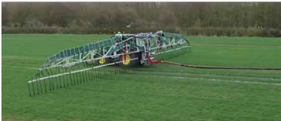
Figura 10.- Sistema umbilical de distribución de purín Vogelsang.
