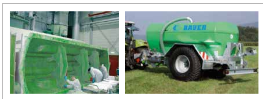
Figura 6.- Cisterna de purín Bauer, de poliéster reforzado con fibra de vidrio. La complejidad de la estructura exige la elaboración a mano para colocar lo más exactamente posible las láminas de fibra de vidrio.
